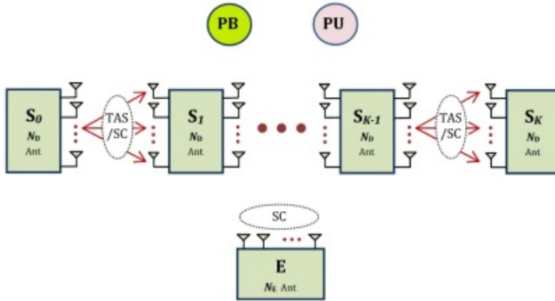
Hình 4.1: Mô hình mạng đa chặng kết hợp thu hoạch năng lượng vô tuyến Mạng thứ cấp MUCRN có các trạm được trang bị N_D đảm nhận truyền tin từ S_0 đến S_K theo giao thức HD, sử dụng phân tập TAS/SC như chương 3. Ngoài ra, các trạm thứ cấp còn thu hoạch năng lượng vô tuyến để truyền tin từ trạm phát năng lượng PB (Power Beacon). Trạm nghe lén sử dụng SC để nghe lén thông tin trong mạng thứ cấp.
